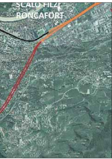
Sopra in nero il tracciato storico, in rosso la galleria di progetto, in giallo i tratti di accesso Qui sotto l'elaborazione grafica di progetto degli imbocchi all'ex scalo Filzi e ad Acquaviva
